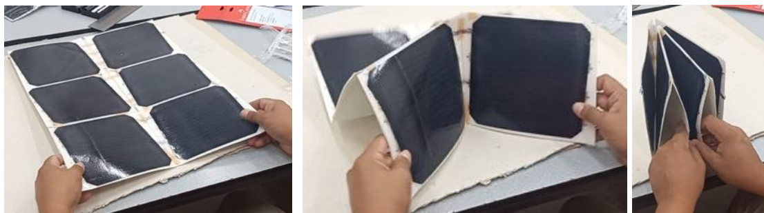
Figura 5. Prototipo básico de 6 celdas solares, proceso de repliegue. (Elaboración propia)
