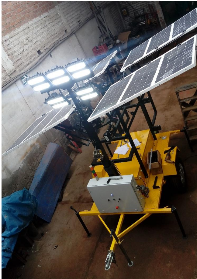
Figura 9. Torre de Iluminación Solar diseñado y fabricado por Dinamo Tecnologías SAC.
