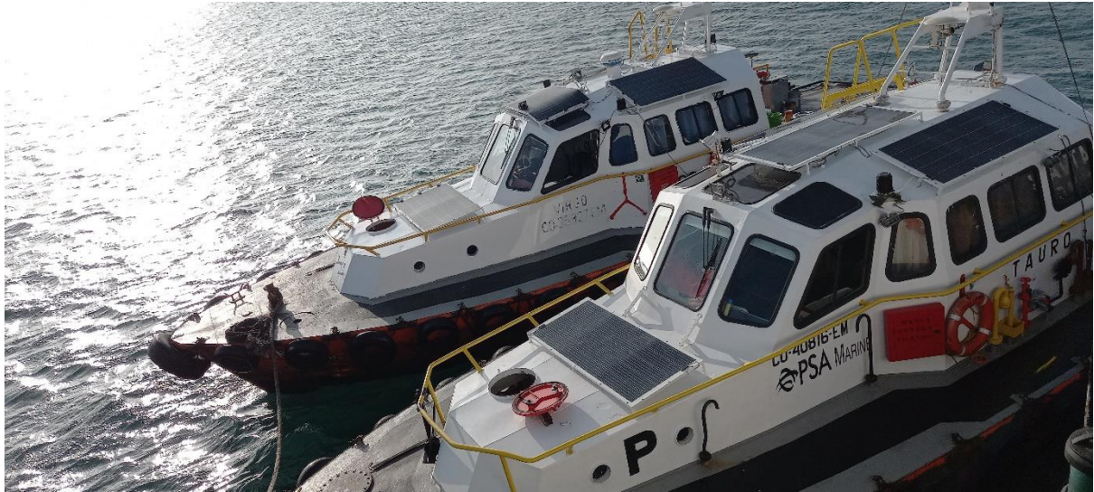
Figura 8. Sistema fotovoltaico híbrido, exitosamente instalado en lanchas Pilot por Dinamo Tecnologías SAC.
