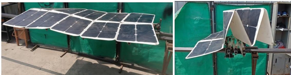
Figura 7. Desarrollo de mecanismo para el repliegue en un solo movimiento. (Elaboración propia)
