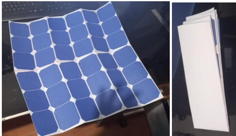
Figura 4. Prototipo de cartulina, considerando geometría de celdas solares. (Elaboración propia)
