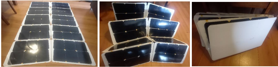
Figura 6. Prototipo Escala Real 60 celdas solares, proceso de repliegue. (Elaboración propia)
