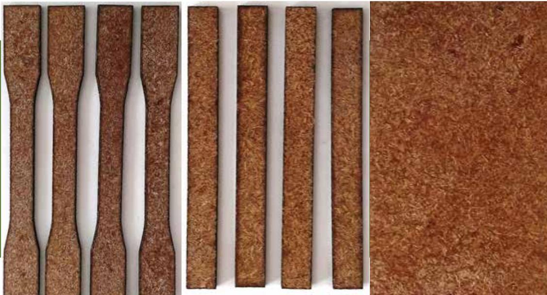
Figura 1. Probetas de compuesto bambú / plástico.
