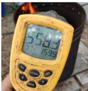
**Figura 4.** Determinación de la temperatura en la pirolisis del bambú *Guadua angustifolia* al elaborar biochar.
