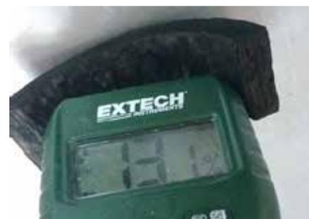
**Figura 5.** Determinación de la humedad del biochar muestra del bambú *Guadua angustifolia*.
