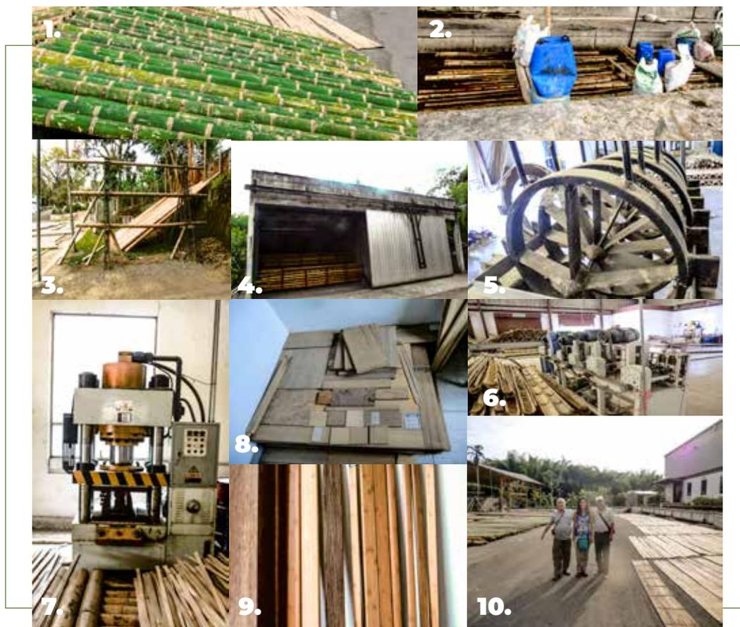
**Figura 6.** INDAGUADUA S.A. **1.** Patio de cañas. **2.** Preservado. **3.** Escurremiento y secado al aire. **4.** Horno de secado. **5.** Aro chino. **6.** Denudadora. **7.** Prensa. **8.** Productos. **9.** Productos. **10.** Equipo CIB.
