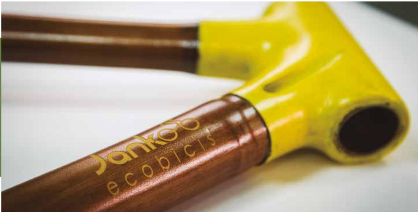
**Figura 1.** INNOVACIÓN Y PERSONALIZACIÓN. Las soldaduras en frío son un desarrollo original de la empresa, cada bicicleta es personalizada con grabado láser de marcas o lemas. Fotografía. Janko
