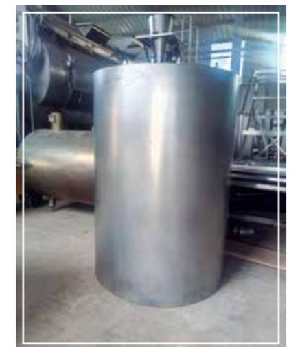
Figura 3. Cámara de autoclave
