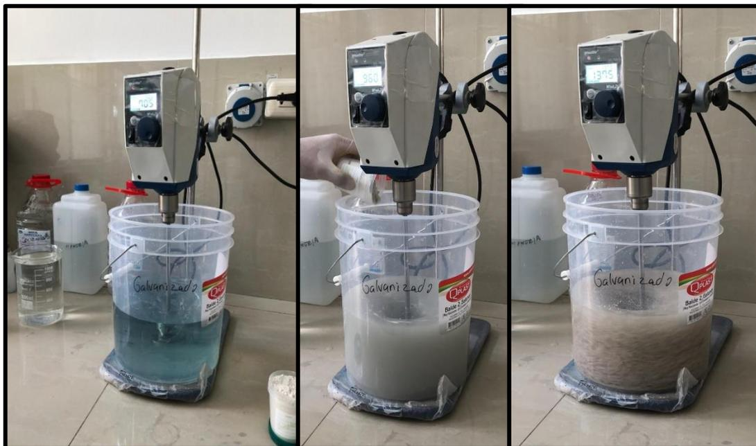
Figura 1: Proceso de Coagulación-Floculación. Fuente: propia
