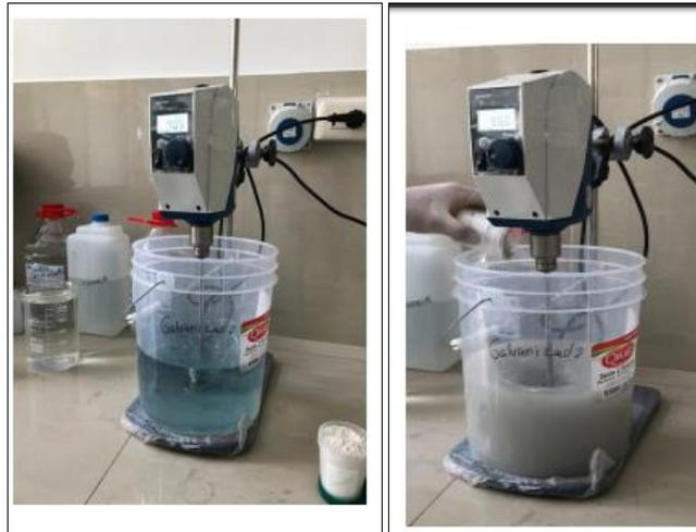
Figura 6: decoloración resultante coagulación – floculación. Fuente: propia
