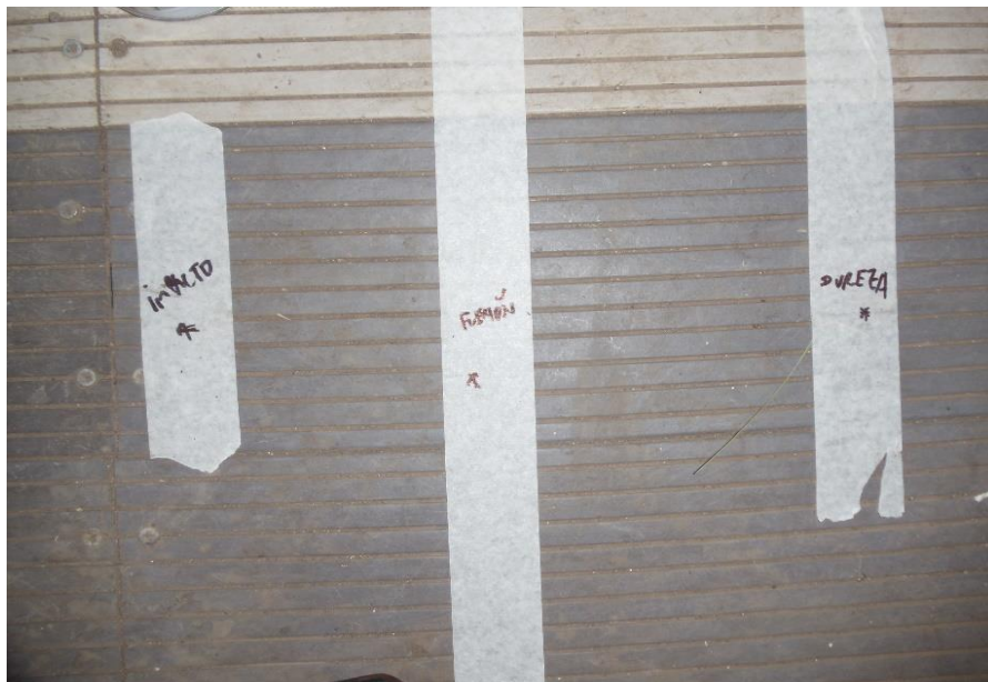
Figura N° 1. Posición en medio de la tabla de ensayo de flexión
